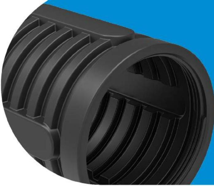
Удлиняющие горловины RODLEX являются винтовыми универсальными изделиями и подходят для использования с колодцами RODLEX D-1000, RODLEX KDU, лотковыми частями RODLEX серии R, а также с кессоном для скважин RODLEX. Горловина увеличивает высоту изделия на 500/1000 мм. Для достижения необходимой высоты используются несколько изделий.
